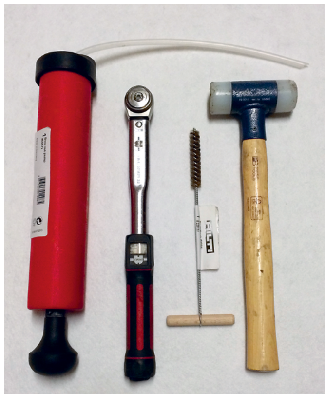
Abb. 22: Werkzeugset mit Drehmomentschlüssel, Ausblaspresse usw. für die Montage der Befestigungspunkte
